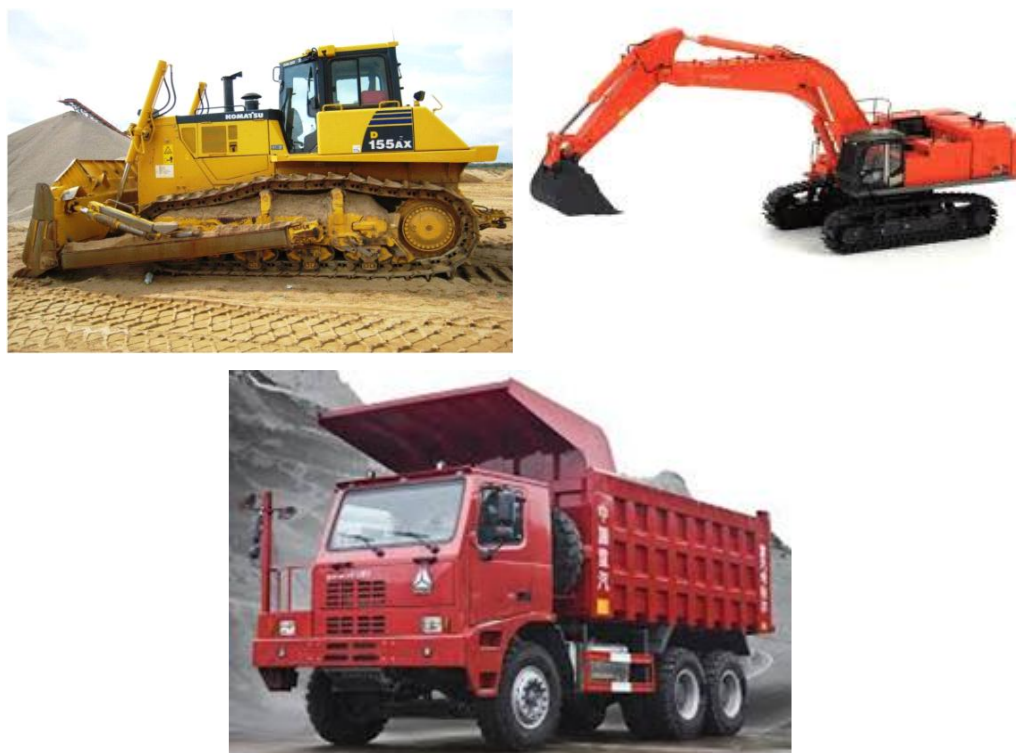
Figura 4. Buldócer Komatsu, Excavadora Craner EK 400 de 1,8m 3 y Camiones HOWO de 30 m 3 empleados en la explotación del yacimiento Los Caliches
