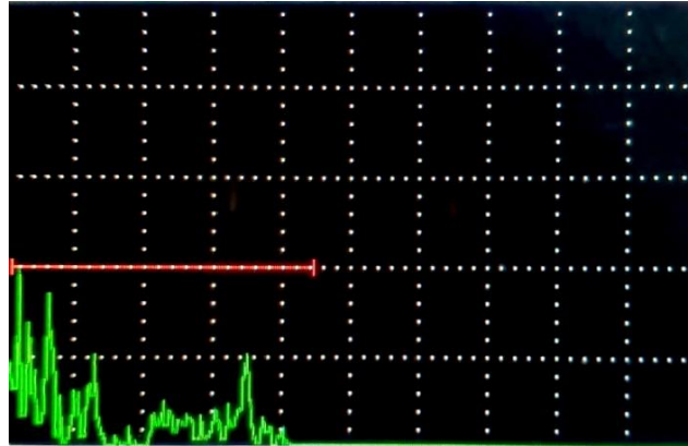
Figura 4. Indicación de la discontinuidad del columpio.
