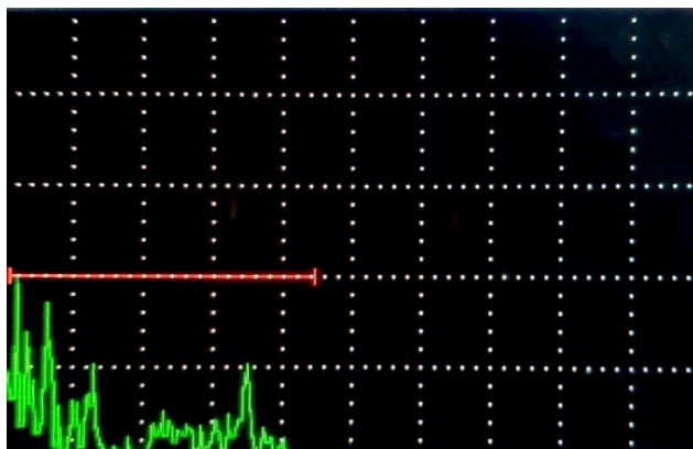
Figura 4. Indicación de la discontinuidad del columpio.
